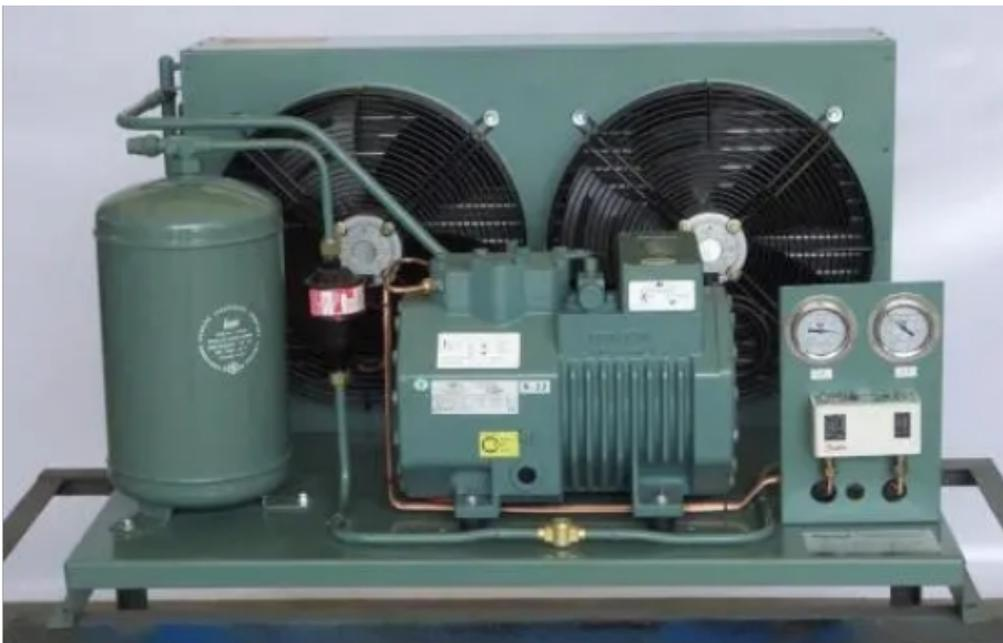
一般制冷机的制冷原理压缩机的作用是把压力较低的蒸汽压缩成压力较高的蒸汽，使蒸汽的体积减小，压力升高。压缩机吸入从蒸发器出来的较低压力的工质蒸汽，使之压力升高后送入冷凝器，在冷凝器中冷凝成压力较高的液体，经节流阀节流后，成为压力较低的液体后，送入蒸发器，在蒸发器中吸热蒸发而成为压力较低的蒸汽，再送入压缩机的入口，从而完成制冷循环。利用外界能量使热量从温度较低的物质（或环境）转移到温度较高的物质（或环境）的系统叫制冷系统。制冷系统可分为蒸气制冷系统、空气制冷系统和热电制冷系统。其中蒸气制冷系统又可分为蒸气压缩式、蒸气吸收式和蒸气喷射式。主要部件组成制冷系统由制冷剂和四大机件，即压缩机，冷凝器，膨胀阀，蒸发器组成。压缩机压缩机是制冷循环的动力，它由电动机拖动而不停地旋转，它除了及时抽出蒸发器内蒸气，维持低温低压外，还通过压缩作用提高制冷剂蒸气的压
